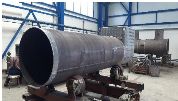
LB - Výroba nového kotla pre parnú lokomotívu Katka.
