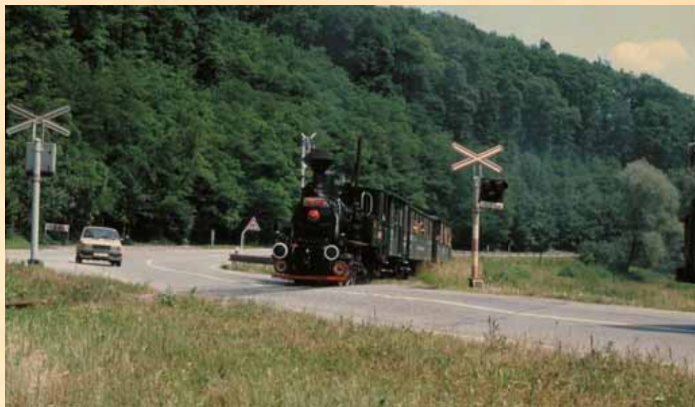
▲ V polovici 90. rokov došlo k výmene cestného zabezpečovacieho zariadenia na priecestí pred staniciou Alpinka. Starší typ SSSR nahradil novší typ AŽD. Jeho činnosť bola závislá od postavenia vlakovkej cesty. Zariadenie sa však v polovici 90. rokov, po zbúraní staničnej budovy na Alpinke, stalo nefunkčné a neskôr bolo odstránené. Priecestie dnes stráži už iba jednoduchá dopravná značka. (foto Jaromír Bittner)
